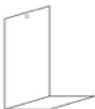
Elektrotauchlacke neigen zu Sedimentationen. Um dies zu minimieren, wird mittels unterschiedlicher mechanischer Verfahren das Absetzverhalten im Lackbecken optimiert. Die L-Blech-Prüfung dient zur Feststellung dieses Absetzverhaltens.
