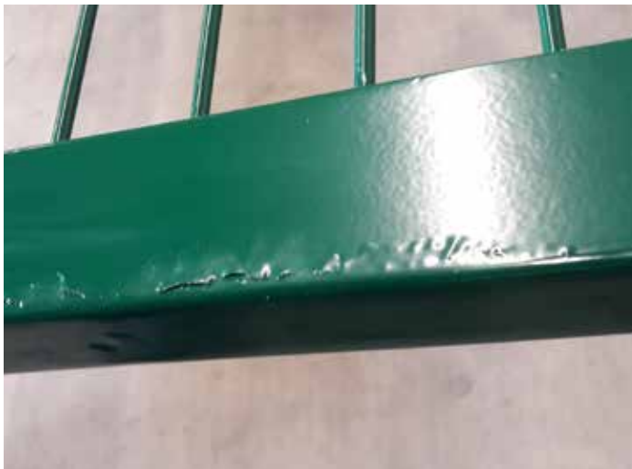
Abbildung 10: Zinkablösung nach der Beschichtung
